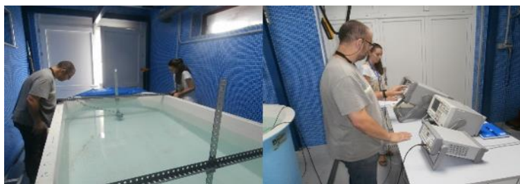
Ilustración 97. Montaje del sistema de medidas en ambiente controlado en la piscina de agua salada de PLOCAN
